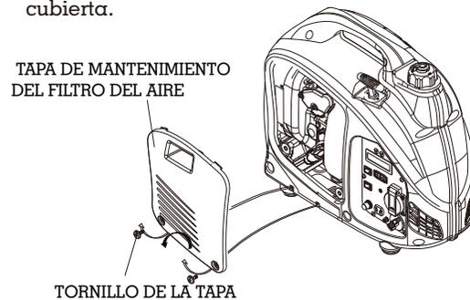
8.2.2) Presione hacia abajo la lengüeta de cierre en la parte superior del filtro del aire y abra la tapa del filtro del aire.
